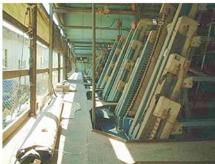
全面カーテンで温度管理。ベルトコンベアで集卵、選別、検卵をします。
